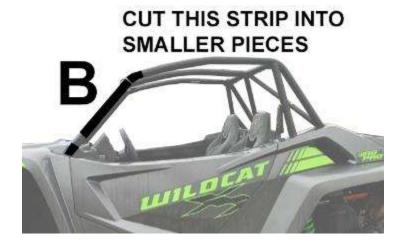
THE BACK OF THE FRONT DOOR WILL MAGNET TO THE SIDE OF THE ROLLBAR.
