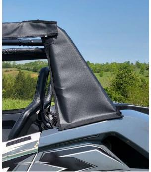
STRIP C SHOULD BE PLACED FACING THE INSIDE OF THE XX. PULL THE TAB ON THE FRONT OF THE BACK DOOR FRAME AROUND THE BAR AND ATTACH THE ADHESIVE VELCRO.
