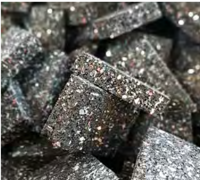
Isopads aus 95 % Altreifengranulat
