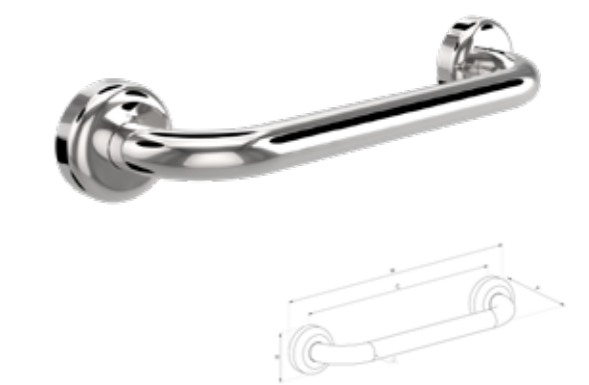
GRAB RAIL NH09 - W - 370 D - 65 P - 85 C - 305 Ø - 25.4 NH10 - W - 522 D - 65 P - 85 C - 457 Ø - 25.4 NH11 - W - 675 D - 65 P - 85 C - 610 Ø - 25.4
