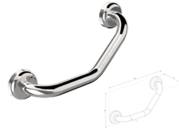
ANGLED GRAB RAIL NH13 - W - 321 D - 172 P - 84 Ø - 25.4 NH14 - W - 440 D - 227 P - 84 Ø - 25.4
