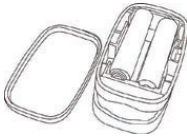
Figura 6. Instalación de las baterías
