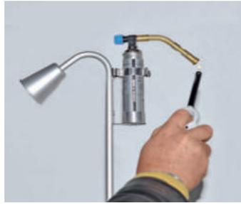
Neben einer sicheren Gewindeverschraubung der Gasampulle Vario mit dem Entnahme-Adapter, lässt sich die Anzündflamme mittels eines Feinregulierventils auf die optimale Flammengröße einstellen.
