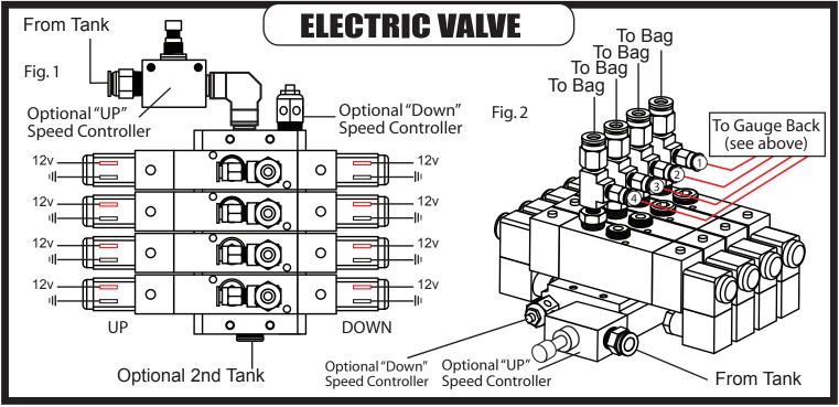
GREEN - REAR RIGHT DOWN FOR PLUG N PLAY **DRANGE - REAR RIGHT UP** CONNECT THE RED WIRE COMING OUT OF THE PLUG GREY - FRONT RIGHT DOWN TO THE PRESSURE SWITCH BLUE - FRONT RIGHT UP BROWN - REAR LEFT DOWN AND THE RED WIRE COMING OUT OF THE LOOM TO +12V YELLOW - REAR LEFT UP WHITE - FRONT LEFT DOWN **BLACK - FRONT LEFT UP** RED - +12V FOR NON PLUG N PLAY AIRBAGIT.COM SWITCH BOXPRESSURE SWITCH RELAYS REQUIRED! NO RELAYS REQUIRED ALVES NOT INCLUDED **VALVES & RELAYS** NOT INCLUDED
