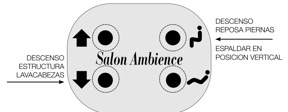
fig.3 descenso del asiento y del reposa piernas.
