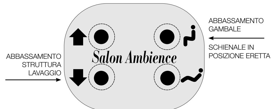
fig.3 Abbassamento della poltrona e del gambale.
