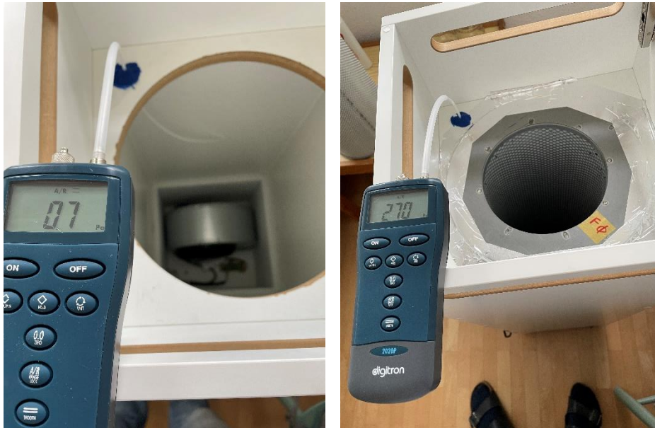
Figure 1: Testaufbau zur Messung des Differenzdrucks. Links: ohne Filterkartusche, rechts: mit abgeklebter Filterkartusche
