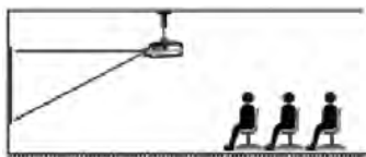
1.Attacco a soffitto a proiezione frontale
