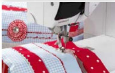
Mit der spanischen Hohlsaumvorrichtung können Stoffkanten in definiertem Abstand verbunden und dekorative Kantenabschlüsse mit Bordüren genäht werden.
