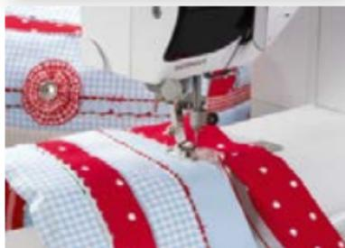
Med spansk hullsøminnretning kan stoffkanter forbindes i definert avstand og dekorative kantavslutninger med border sys.
