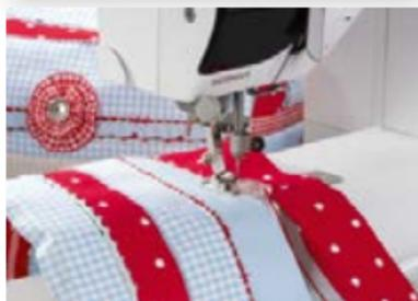
С помощью устройства для испанской мережки можно шить соединенные на определенном расстоянии края ткани и декоративные отделки краев с бордюрами.
