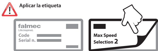
Fig. 2: Configure como máximo 2 velocidades:
