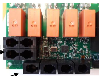
Rysunek 4 . Kolejność złączy RJ 10. Czujnik, przełącznik drzwiowy, sterowanie zdalne, dodatkowe NTC
