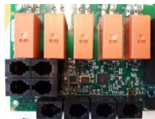
Рис 4 Расположение разъемов RJ 10. Датчик, дверной выключатель, дистанционное управление, дополнительный датчик NTC
