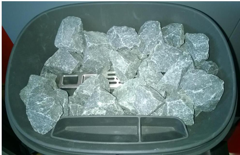
**Nota: Rellene el espacio reservado para las piedras hasta que queden cubiertas las bobinas superiores de las resistencias.**
