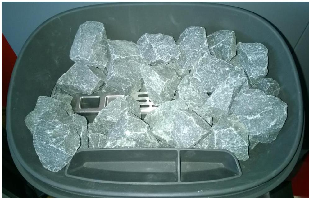
**OBS! Fyll stenutrymmet tills de över resistorelementen täcks.**
