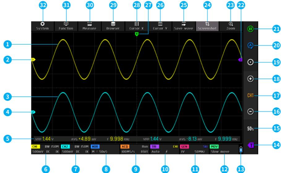
①La forma de onda de la señal del canal 1 se muestra en un brillo amarillo cuando la temperatura de color está apagada. Cuanto más brillante sea el área, mayor será la probabilidad de que aparezca el área. Cuando la temperatura de color está encendida, se muestra como una transición de color. La temperatura aumenta gradualmente de azul a rojo, lo que significa que la probabilidad de que aparezca el área es mayor.
