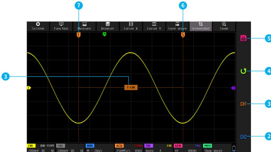
① Intercetar canal e marca de período, T-CH1 significa intercetar esta secção da forma de onda do canal 1 como um sinal periódico.
