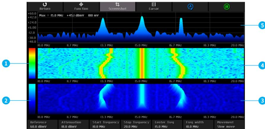
①Rango de colores del gráfico de cascada, el azul en la parte inferior indica el color con la ganancia más baja, el rojo en la parte superior indica el color con la ganancia más alta.
