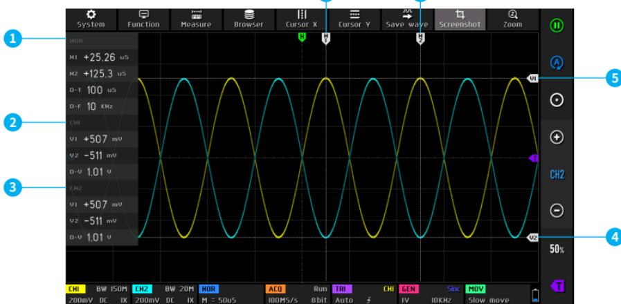
①Barra de parámetros del cursor de tiempo X, donde H1/H2 se refiere al tiempo de la línea del cursor H1/H2 en relación con el centro de coordenadas. D-T se refiere al valor absoluto de la diferencia de tiempo entre H1 y H2. D-F se refiere al valor de frecuencia correspondiente a los ciclos H1 y H2.
