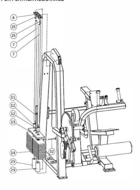
**STEP 5:** HANG THE TWO GUARD PLATES ON THE SCREWS OF THE DOOR FRAME ASSEMBLY, AND INSTALL THE PLATIC PULLEY COVER THE WEIGHT STACK FRAME.
