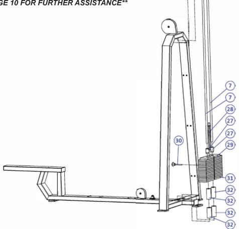
**STEP 3:** INSTALL THE SUPPORT UPRIGHT ASSEMBLY TO THE UNDER FRAME ASSEMBLY(4).
