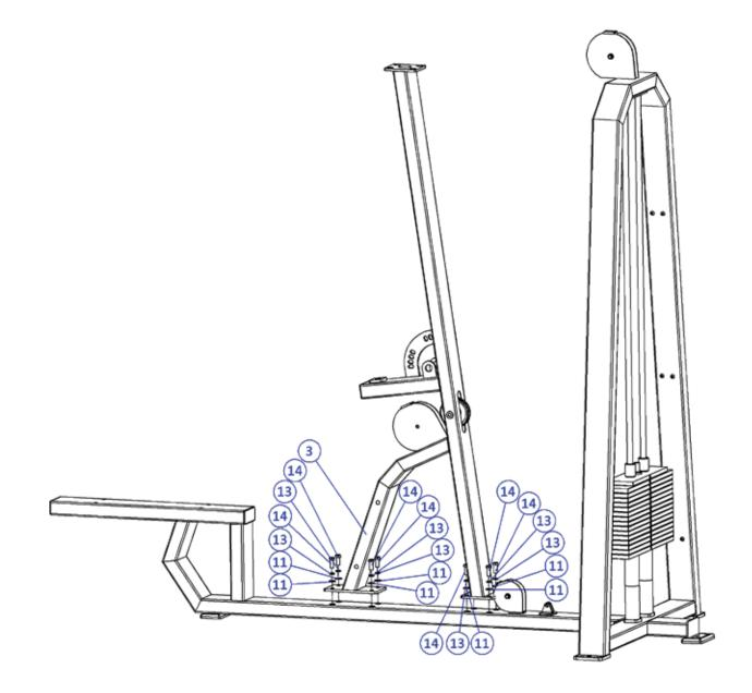
**STEP 4:** INSTALL THE UPPER CONNECTING CROSS BEAM TO THE WEIGHT STACK FRAME AND THE SUPPORT UPRIGHT ASSEMBLY.
