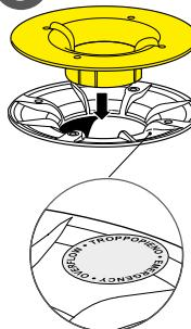
Använd skyddslocket ända tills monteringen är klar. Det kan användas för tillfällig avvattnning genom att avlägsna klisterplappen som täcker hålen. Om brunnen används som bråddavlopp märks den ut med bifogat klistermärke.
