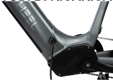
A. Ricarica della batteria direttamente sulla e-bike.
