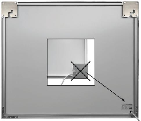
Les 2 vis à tête fraisée (D) doivent être fixées sur le cadre; partie inférieure dans les écrous prévus à cet effet et les pousser vers l'extérieur avant de les serrer. Ces vis permettent de laisser la distance minimale obligatoire entre le mur et l'élément de chauffage.
