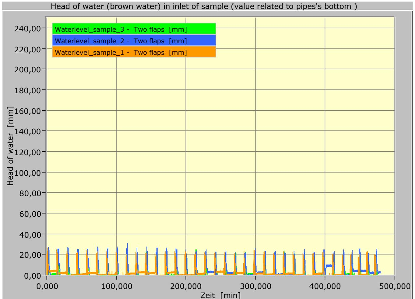
Die obige Darstellung zeigt den Wasserstand im Zulauf der 3 Prüfstücke über die Zeit (Prüfzyklen A und B). Die einzelnen Peaks geben den sich einstellenden Wasserstand während des Zuflusses (Schritt Nr. 1 bzw, 9 von Tabelle 1 in EN 13564-2) in Durchflussrichtung wieder.
