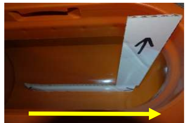
Montagewinkel in Putzöffnung einführen
