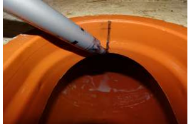
Symmetrieachse vorne und hinten ebenfalls markieren
