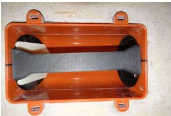
symmetrischen Fixierteil aufsetzen - Nut muss auf beiden Seiten in Feder einrasten
