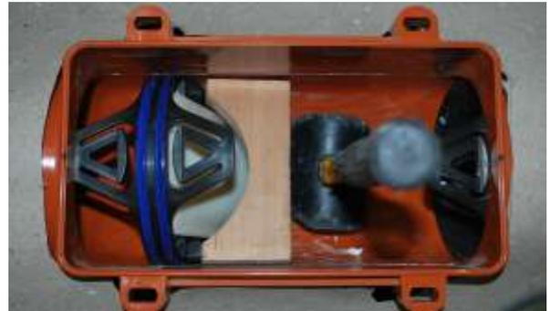
zweite Klappe BLAU mit blauen Dichtungen in Gegenfließrichtung montieren
