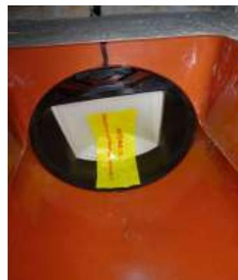
Montagklebeband für 1. Klappe entfernen
