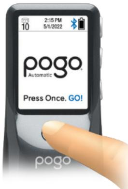
El Sistema POGO Automatic es un nuevo modo de prueba. POGO Automatic cuenta con la tecnología All-Automatic™, lo que significa que la punción y la obtención de sangre se combinan en un solo y sencillo paso. Solo debe colocar su dedo en el puerto de prueba y presionar. El medidor automáticamente perfora su dedo y recoge su muestra de sangre sin necesidad de suministros separados.
