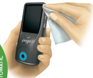
Asegúrese de desinfectar todas las superficies exteriores del medidor, incluyendo los botones y las ranuras.
