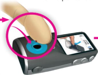
Alinee la gota de sangre por sobre el orificio del puerto de prueba.
