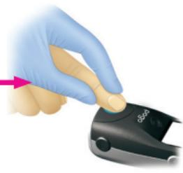
Centre y PRESIONE en la celda de prueba. SOSTENGA hasta que el medidor se lo indique.
