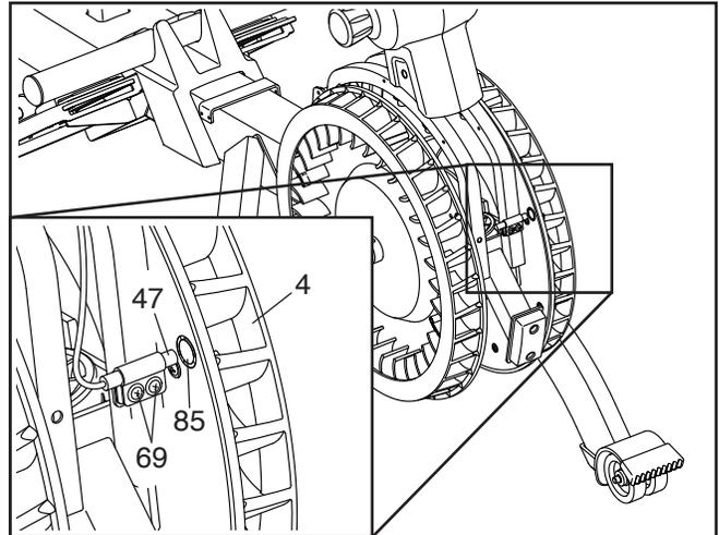
Stecken Sie den Stromadapter ein und drehen Sie den linken Ventilator (4), sodass der Magnet (85) den Reedschalter (47) mehrmals passiert. Wiederholen Sie den oben beschriebenen Vorgang, bis der Trainingscomputer richtige Rückmeldungen anzeigt.
