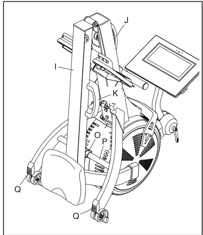
Um das Rudergerät auseinanderzuklappen, stemmen Sie als Erstes Ihren Fuß gegen einen Stabilisatorfuß (Q) und ziehen den Schienengriff (K) nach außen, um die Klappstellungsklemme (O) zu lösen.
