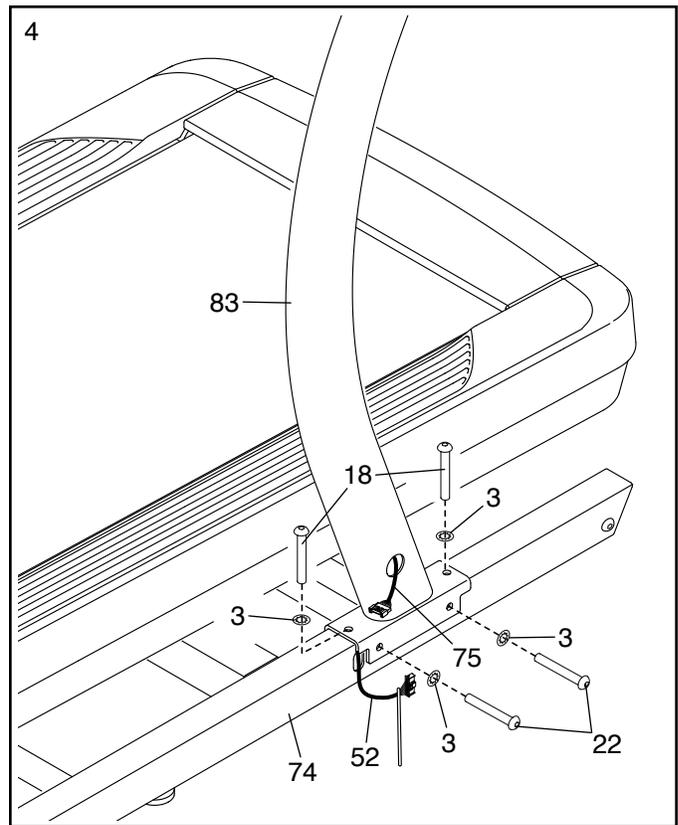
5. Stecken Sie das Basiskabel (52) mit dem Pfostenkabel (75) zusammen. **Die Verbindungsstecker sollen ohne Schwierigkeit ineinander passen und einschnappen. Falls nicht, drehen Sie einen Verbindungsstecker um und versuchen es noch einmal.**
