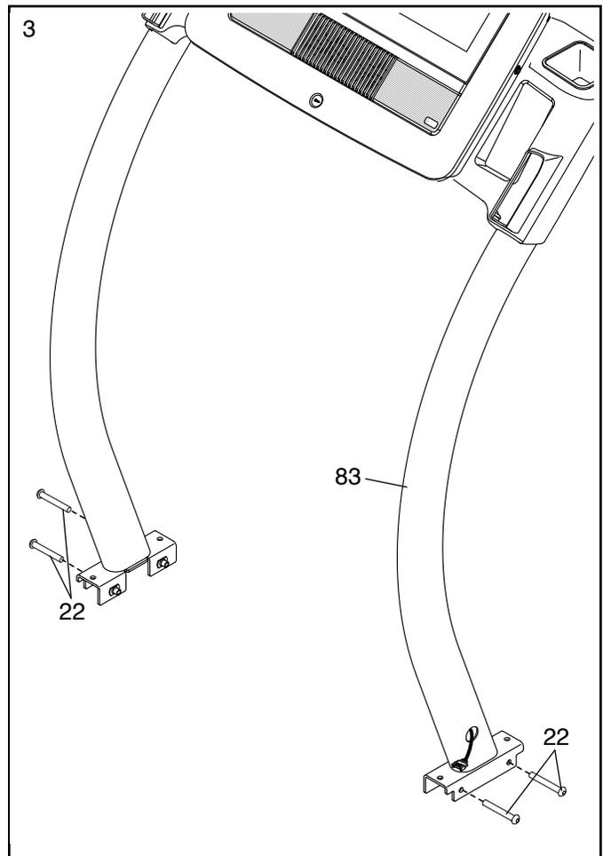
4. Stellen Sie die Pfosten (83) auf die Basis (74). **Achten Sie darauf, dass sich das Loch mit dem Pfostenkabel (75) auf der rechten Seite befindet.**
