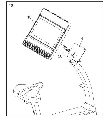
Tipp: Vermeiden Sie es, die Kabel einzuklemmen. Befestigen Sie den Trainingscomputer (13) mit vier M4 x 18mm Schrauben (34) am Pfosten (4). Drehen Sie anfangs alle Schrauben lose ein, dann ziehen Sie diese fest.
