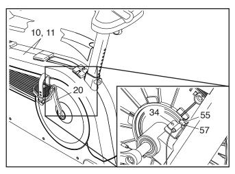
lockern Sie die M4 x 18mm Schraube (34) ein wenig, schieben Sie den Reedschalter leicht zum Magneten hin oder davon weg und ziehen Sie dann die Schraube wieder fest.
