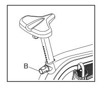
los. Bewegen Sie die Sitzstütze leicht aufwärts oder abwärts, um sicherzustellen, dass der Knauf in einem der Einstelllöcher an der Sitzstütze eingerastet ist. Dann ziehen Sie den Knauf fest.
