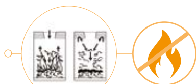
Principio di autoestinzione Flame-extinguishing process
