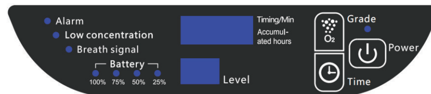
Figura 4 – Diagrama del Panel Operativo
