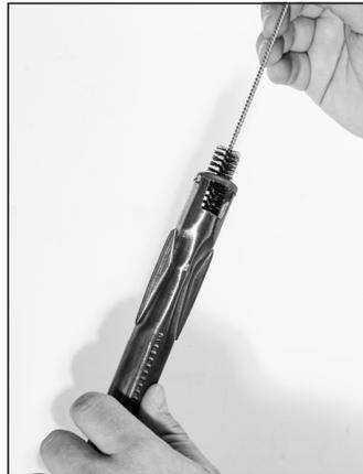
**PASO 04** Cepille toda la superficie exterior del quemador para eliminar la suciedad.
