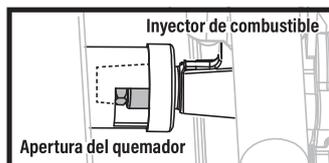
⚠ La boquilla de combustible del riel de gas debe volver a conectarse dentro de la apertura del quemador.
