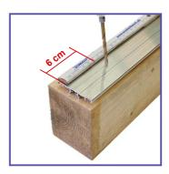
Profiloberteile im Abstand von 40 cm mittig vorbohren (Ø 7 mm). Der Abstand der ersten Bohrung zur vorderen Kante beträgt 6 cm.
