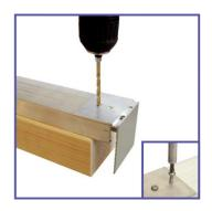
Legen Sie den Abschluss- und Haltewinkel an der Unterseite des Unterprofils so an der Kante an, dass der Wasserablauf frei bleibt (siehe Bild). Bohren Sie nun das Unterprofil 2 mal (Ø 3,5 mm) vor.
