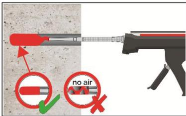
7a. **Injizieren ohne Verfüllstutzen VS:**
