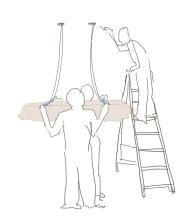
3.REMOVE THE CABLE TIES WHICH CONNECT THE ENDS OF THE BATTENS TO THE PLYWOOD CRADLE. A QUALIFIED ELECTRICIAN SHOULD CONNECT THE LIGHT AND FIX THE DROP OF THE SUSPENSION WIRE. ENSURING THAT THE LIGHT SITS LEVEL.
