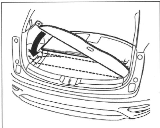
1: Pour retirer le couvercle, inversez l'étape 4 de la méthode d'installation. Lorsque vous retirez le couvercle, tirez-le légèrement vers le haut en diagonale.
