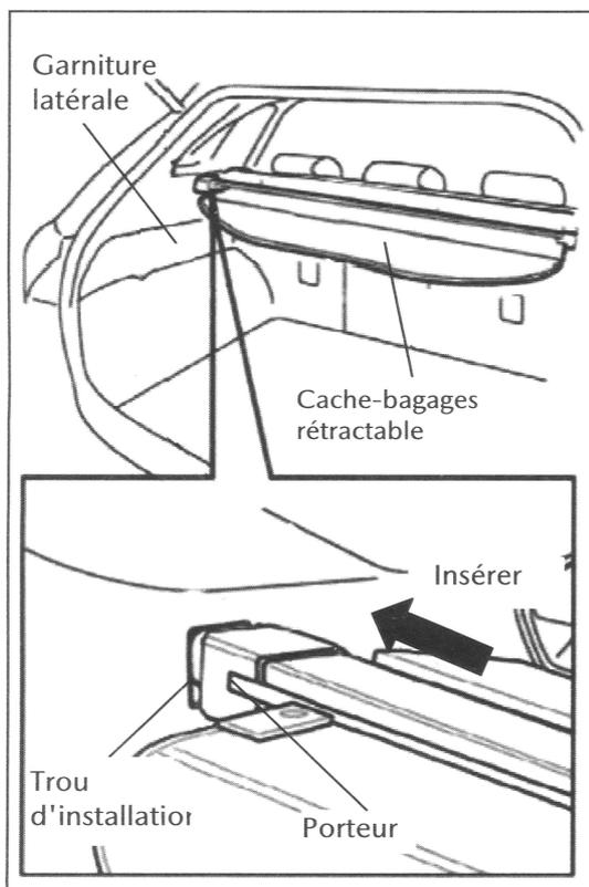
3: Tout en tirant sur le capuchon en plastique, insérez le support côté gauche du cache-bagages rétractable dans la garniture latérale du coffre.
