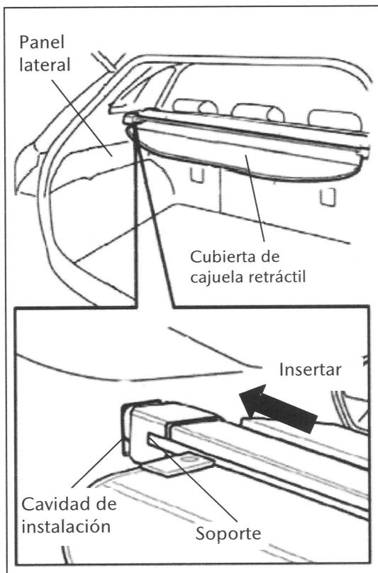
3: Mientras retrae la cubierta de plástico, inserte el soporte del lado izquierdo de la cubierta de cajuela retráctil en la cavidad de instalación del panel lateral de la cajuela.
