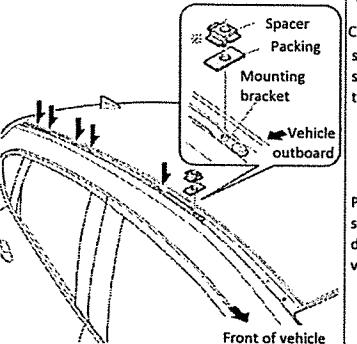
Coloque el empaque y el espaciador sobre la tuerca de soldadura del soporte de montaje del carril de techo del vehículo (6 lugares).
