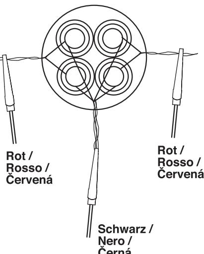
**Vorsicht:** Alle Verbindungen sorgfältig überprüfen. Sicherstellen, dass die Klemmen nicht einander oder den metallischen Explosionsdeflektor berühren. Sicherstellen, dass keine der verflochtenen Starterkabelböndel lose geworden sind. Falls ja, Klemmen trennen, die Rakete von der Startrampe entfernen und die Starterkabel neu verflechten. /
