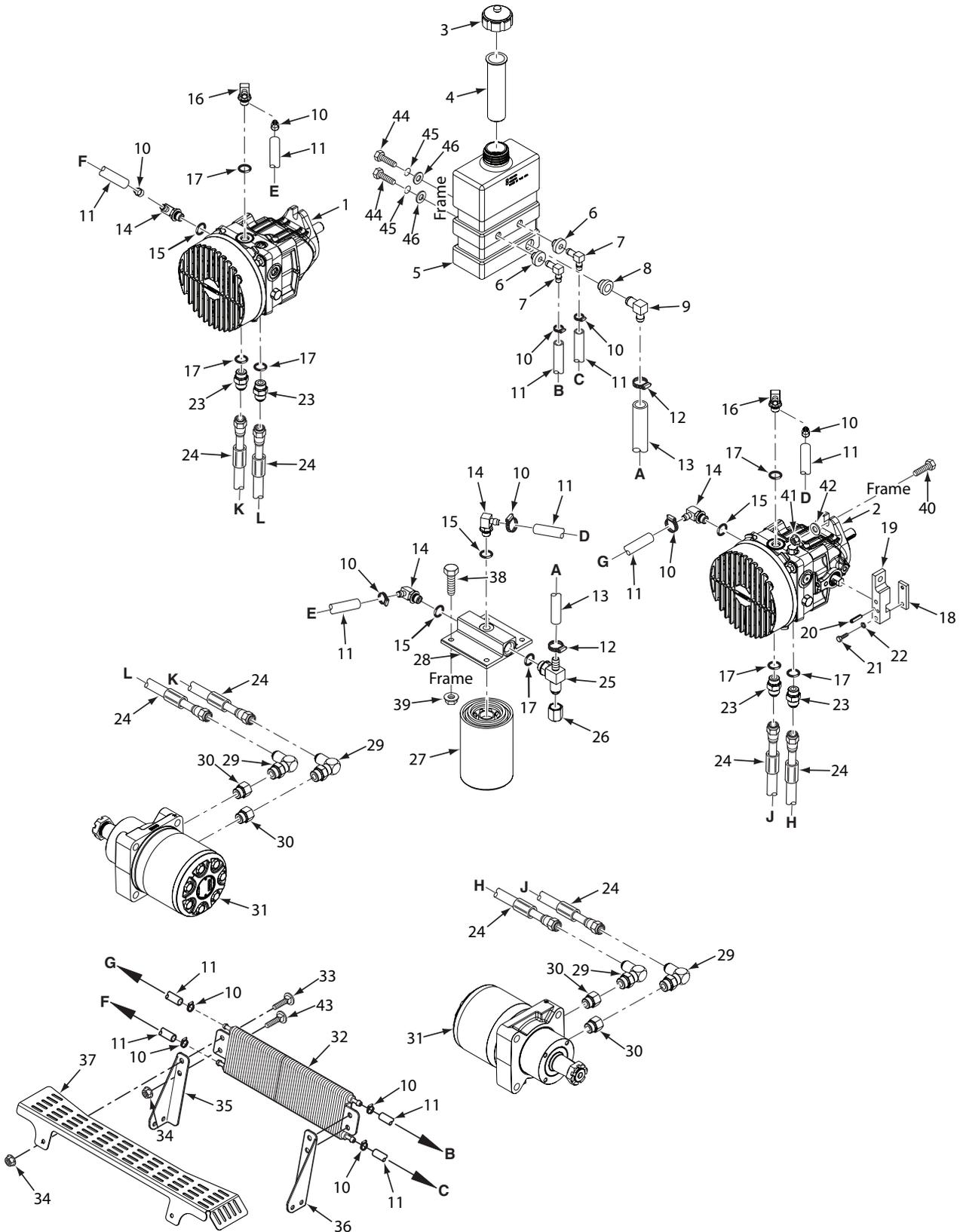
STTII HYDRAULIC SYSTEM - DUAL CORE COOLER
