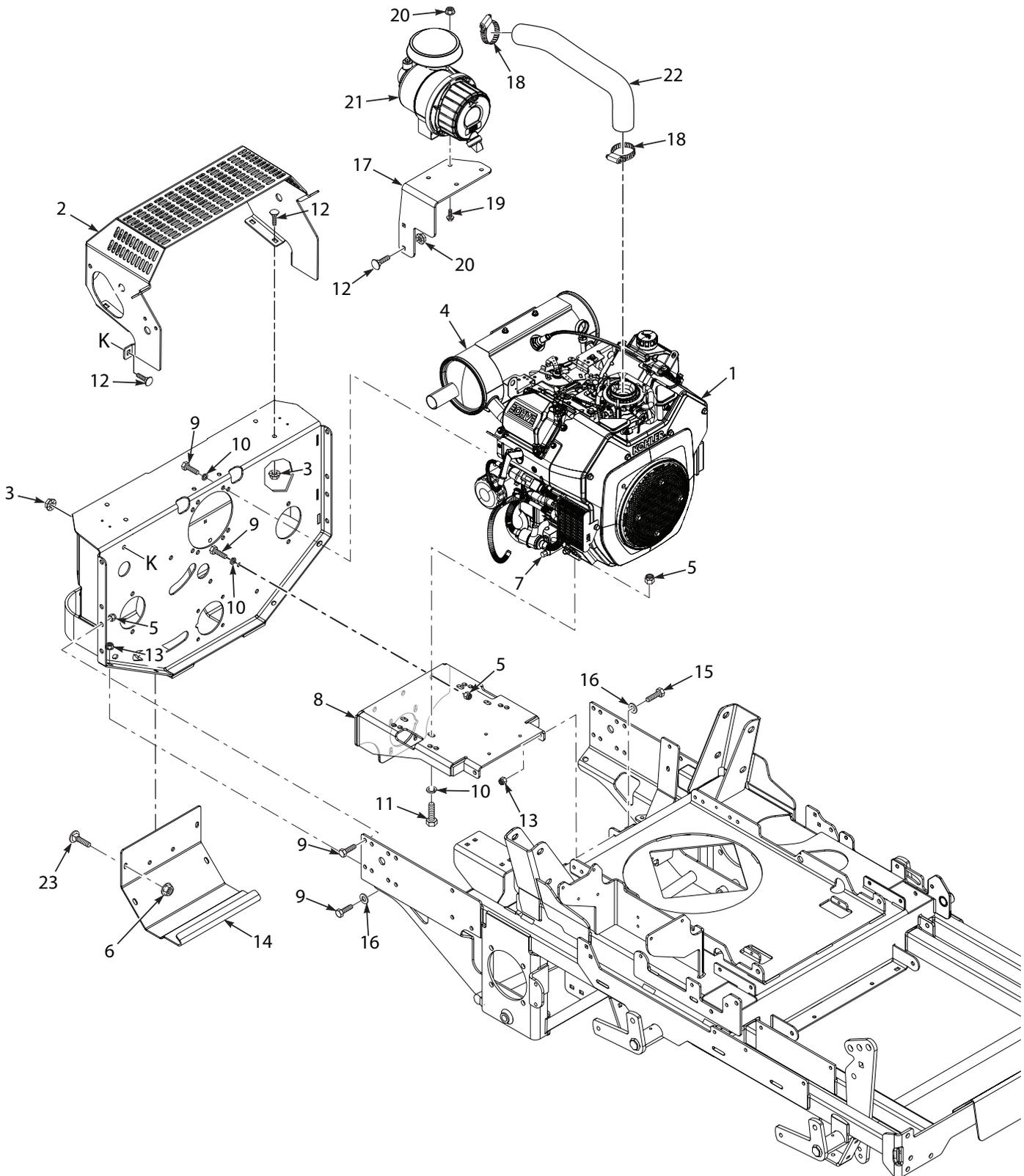
**STTII ENGINE & ATTACHING PARTS - KOHLER 25CH-LP-EFI**
