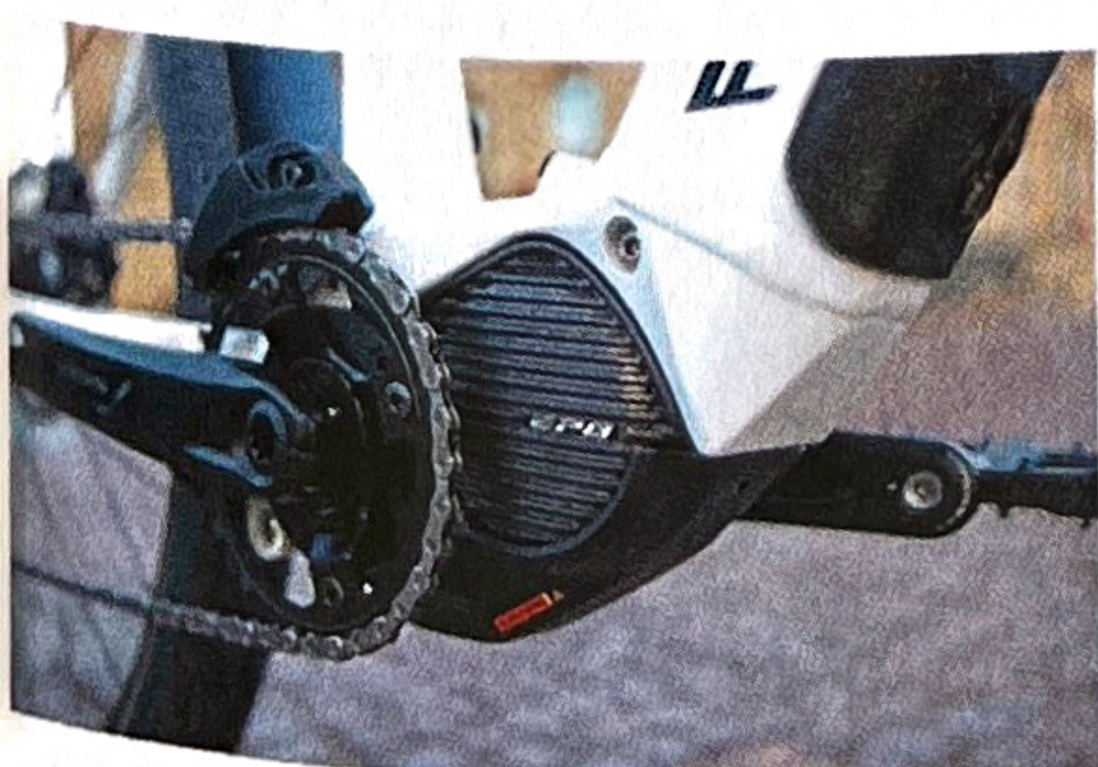
Stark: Der Shimano EP8 bietet bis 85 Nm Drehmoment in drei Modi.
