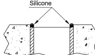
2. Kiểm tra bề mặt ống thải./ Checking top surface of the outlet pipe. Ông thải chỉ được cao hơn 1mm hoặc thấp hơn 2mm so với mặt sàn./ The outlet pipe is only allowed taller 1mm or lower 2mm than the floor.
