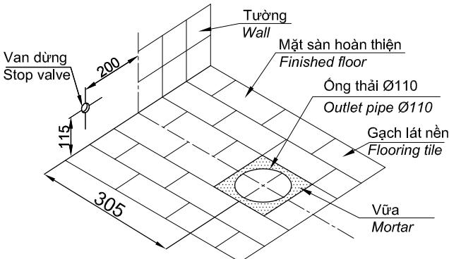
**Chú ý:** Trường hợp cắt gạch không làm kín khít xung quanh ống thải thì phải làm phẳng với vữa và cao bằng mặt sàn hoàn thiện. Vữa phải khô mới được tiến hành các bước tiếp theo.
