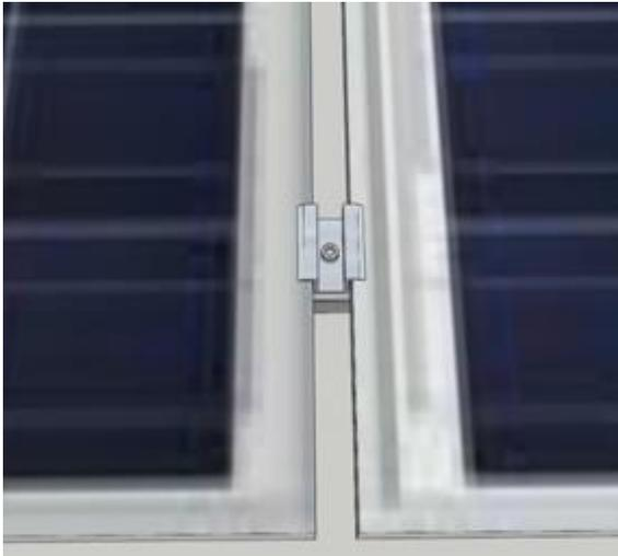
*Abbildung 13/ Anbringen der mittleren Modulklemme*
