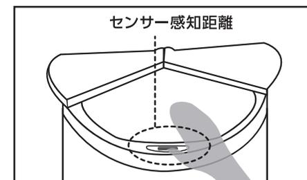
※自動開閉モード中に、センサーボタンを一回押すと羽根は開ききった状態で停止します。もう一度、センサーボタンを押すと、自動開閉モードに戻ります。
