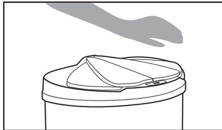
※説明書通りに操作しても、上手く反応しない場合は、主電源スイッチをOFF(○)にしてから、電池カバーを開け、電池の抜き差しをしてからやり直してください。
