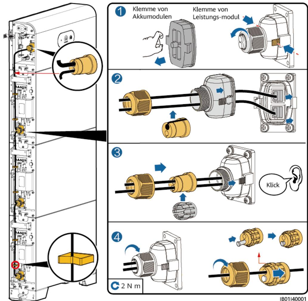
Abbildung 5-5 Befestigen mit Schrauben
