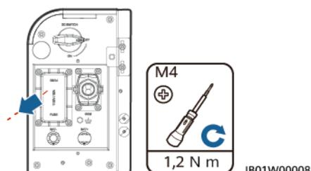
Heben Sie die Abdeckung des Sicherungskastens an, entfernen Sie die Sicherung, setzen Sie eine neue ein und schließen Sie den Sicherungskasten wieder. Wenn Sie ein Klickgeräusch hören und die Wölbung an der Seite sich innerhalb des Kastens befindet, ist der Sicherungskasten ordnungsgemäß installiert.
