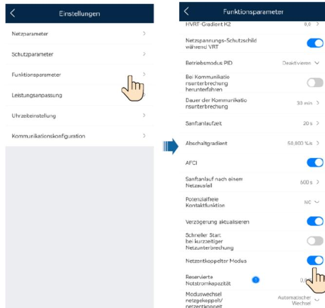
Tabelle 3-9 Einstellen der Parameter für netzgekoppelten und netzentkoppelten Modus
