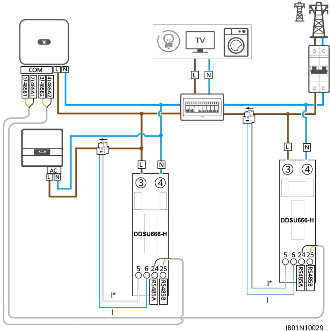
**Tabelle 3-10** Kabelanschlüsse für Leistungsmesser an SUN2000-(2KTL-6KTL)-L1
