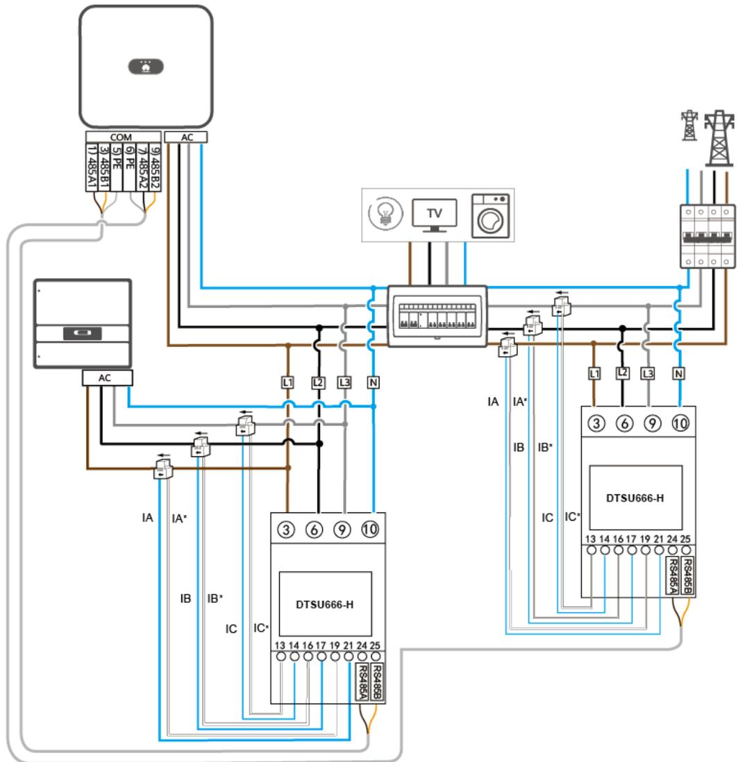
Tabelle 3-11 Kabelanschlüsse für Leistungsmesser an SUN2000-(3KTL-10KTL)-M1
