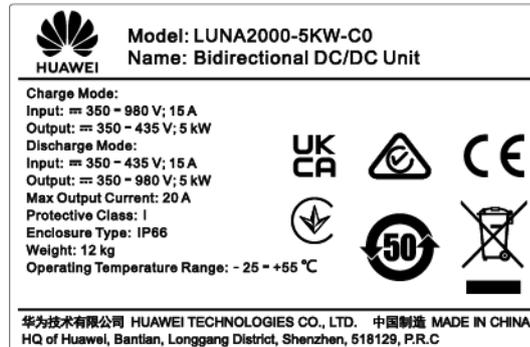
Abbildung 2-10 Typenschild (Akkuerweiterungsmodul)
