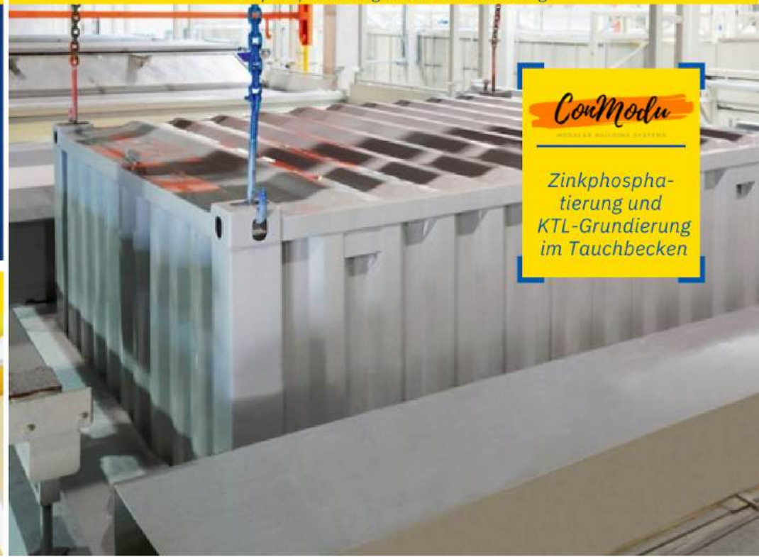
Zinkphosphatierung und KTL-Grundierung
