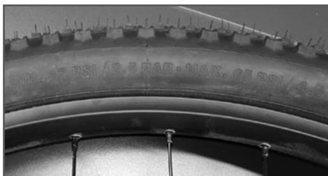
Verifique o encaixe correto a partir da linha de controle dos pneus que passa por cima do aro. Esta linha deve dar a volta completa no pneu, mantendo sempre a mesma distância do aro .
