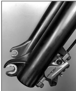
Assegure-se de que o aperto rápido assenta corretamente e volte a instalar imediatamente o freio, se necessário.
