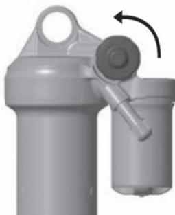
**2.** Comece calibrando a pressão do ar em psi aconselhada para o peso do seu corpo. Com a bomba de ar colocada na válvula de ar, vagarosamente comprima o amortecedor para aproximadamente 25% do seu curso por umas 10 vezes até atingir a pressão do ar deseja. Isto irá equalizar as câmaras de ar positiva e negativa e alterar a pressão no mostrador da bomba de ar.
