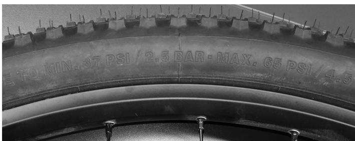
Verifique o encaixe correto a partir da linha de controle dos pneus que passa por cima do aro. Esta linha deve dar a volta completa no pneu, mantendo sempre a mesma distância do aro.
