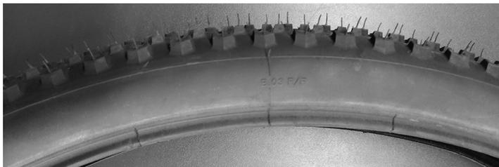
Encha os pneus até à pressão de ar máxima recomendada. A pressão está, normalmente, indicada na parte lateral do pneu.
