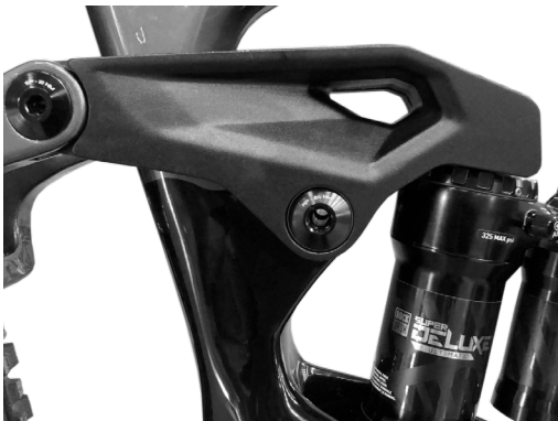
Balança: ambos lados: esquerdo e direito #1 Parafuso Central e #4 Pivot Superior Dianteiro Seat Stay
