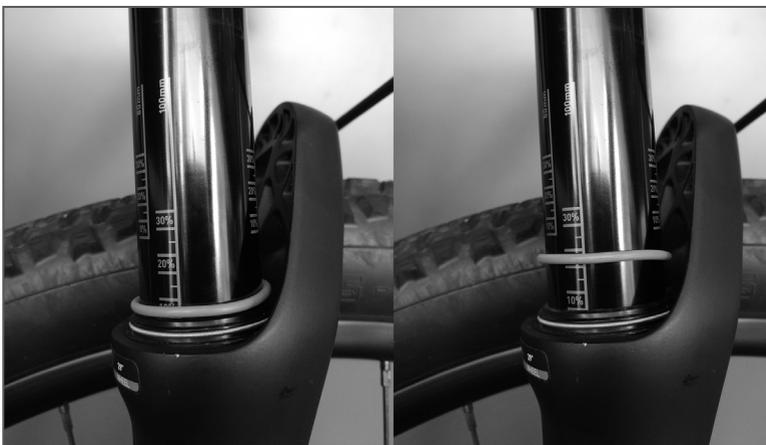
Algumas bicicletas são equipadas com um anel de borracha na canela da suspensão para facilitar a medição.
