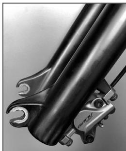
Assegure-se de que o aperto rápido assenta corretamente e volte a instalar imediatamente o travão, se necessário.
