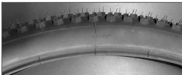
Encha os pneus até à pressão de ar máxima recomendada. A pressão está, normalmente, indicada na parte lateral do pneu.
