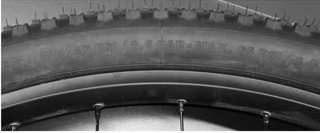
Verifique o encaixe correto a partir da linha de controle dos pneus que passa por cima do aro. Esta linha deve dar a volta completa no pneu, mantendo sempre a mesma distância do aro.
